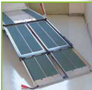
An integrated loading ramp with non-skid surface makes wheelchair boarding easy Die integrierte Laderampe mit rutschfester Oberfläche ermöglicht leichtes Auffahren
