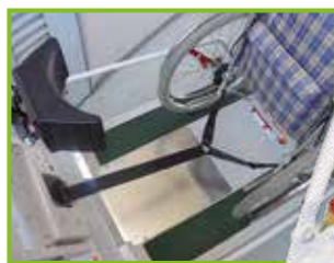
Electrical loading winch to pull the wheelchair Elektrische Winde zum Ziehen des Rollstuhls
